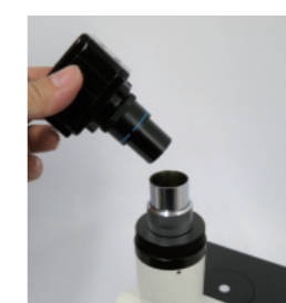
Có thể lắp camera dùng cho kính hiển vi vào bộ chuyển đổi JIS (Tùy chọn)
