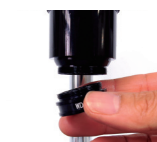
Ống kính hỗ trợ được lắp đặt ở đầu ống kính.
