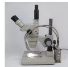
Đèn LED độ sáng cao với cánh tay dài tối ưu để quan sát bằng kính hiển vi
