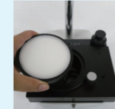
Nó có thể được lắp đặt thay cho tấm quan sát \phi 95\text{mm} của bàn quay XY đơn giản TK180-K (được bán riêng, tr.51)
